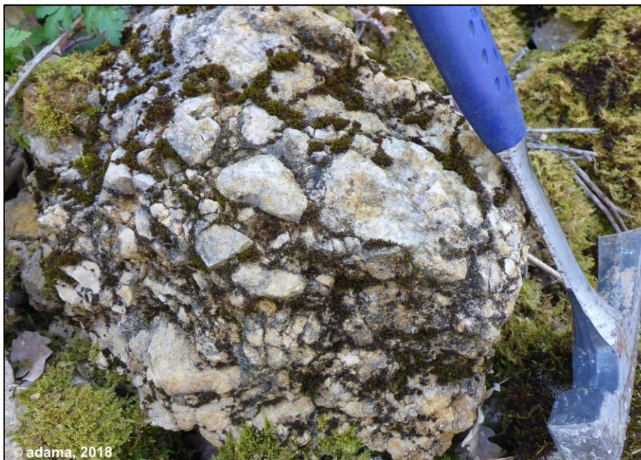
Figure 46. Indices indirects de la présence d'une faille à proximité : bloc de brèche tectonique et de calcite
